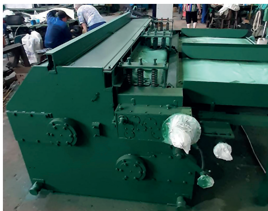
Рис. 2. Машина трепальная одно-процессная двухручьевая марки МТОФ-1М на заводе-изготовителе в ФГБНУ ФНЦ ЛК (г. Тверь): а – вид сбоку; б – вид сзади
