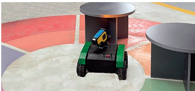
Рис. 2. Физическая модель беспилотной самоходной машины сельскохозяйственного назначения
