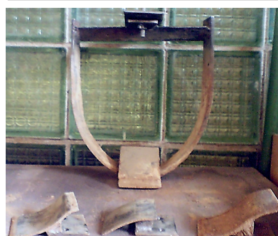
Рис. 5. Модель U-образного рабочего органа объемного рыхлителя с лемехами разного характера кривизны
