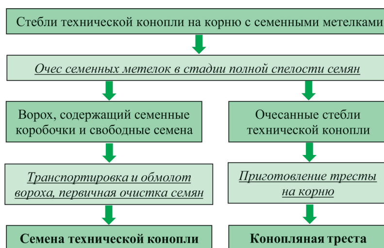
Рис. 3. Схема способа уборки технической конопли с очесом на корню
