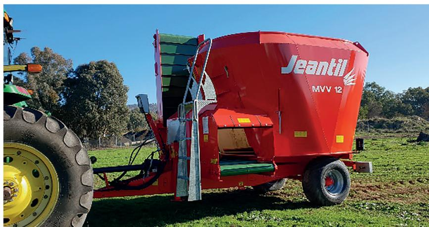
Рис. 5. Мобильный смеситель-раздатчик кормов Jeantil MVV 12 с дополнительным транспортером
