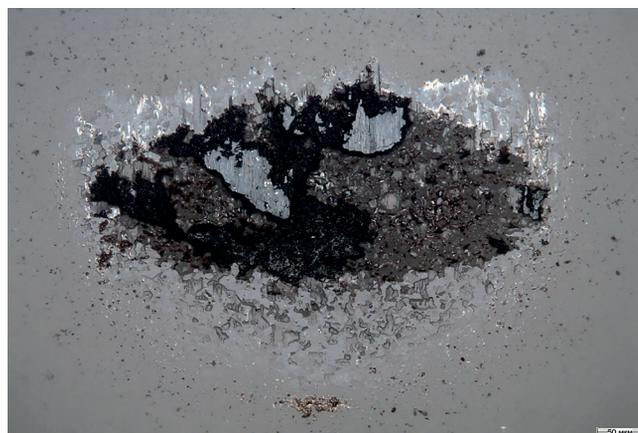
Рис. 4. Оптическое изображение пятна износа контртела
