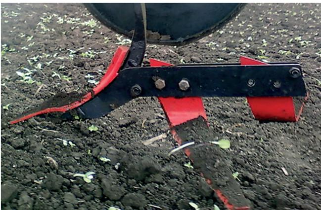
**Рис. 2. Основной рабочий орган нового парового культиватора**
