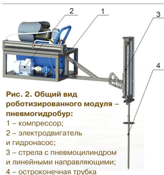
**Рис. 2. Общий вид роботизированного модуля – пневмогидробур:**
