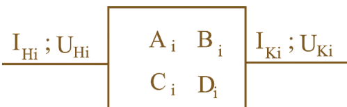
Рис. 2. Упрощенный 2К-полюсник участка линии
