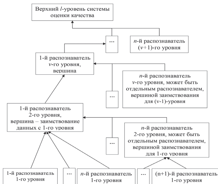
Рис. 1. Схема алгоритма последовательного формирования «распознавателей» с последующей их трансформацией в информационные «вершины»
