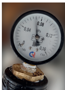
Рис. 1. Лабораторная установка: общий вид (а), схема установки (б), показания манометров РОСМА ТМ-310Р (0-0,16 МПа) и MPF (0-6 бар) перед краном на нагнетательной ветви (в), манометров трубы Вентури (г), вакуумметра РОСМА ТМ-310Р (от 0 до -0,1 МПа) во всасывающем трубопроводе (д), манометра, установленного перед кавитатором (е)
