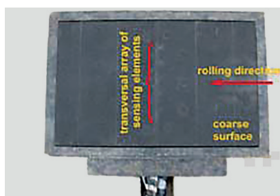
Рис. 3. Общий вид сенсора (слева) и схема установки сенсорной линейки в дорожное полотно (справа)
