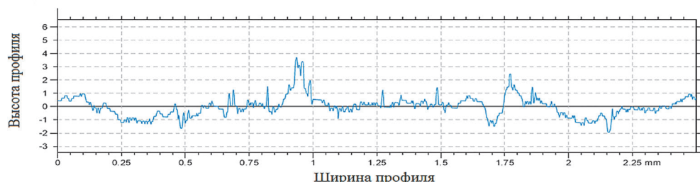
Рис. 4. Профилограмма поверхности композиционного электрохимического покрытия с добавлением электроэрозионной шихты Т30К4
