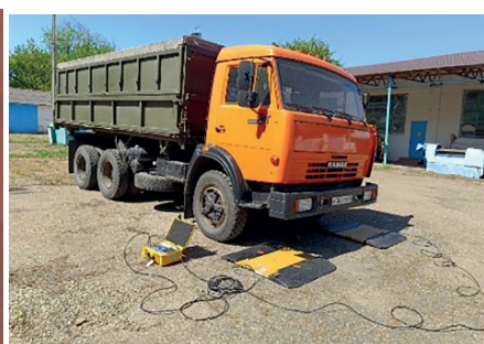
Рис. 2. Определение площади пятна контакта шин с опорой и осевых нагрузок у КАМАЗ-53205
