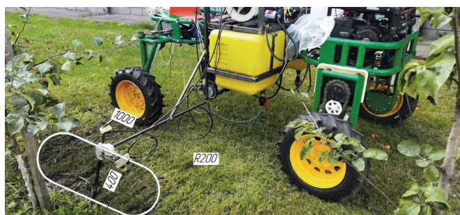
Рис. 3. Устройство гидрообработки приствольных зон садовых насаждений, смонтированное на УРП, и размеры зоны обработки
