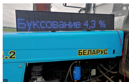
Рис. 5. Пример отображения показателей на экране информационной системы:
