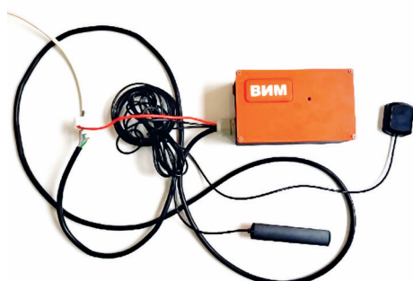
Рис. 1. Устройство по сбору диагностической информации через CAN-интерфейс
