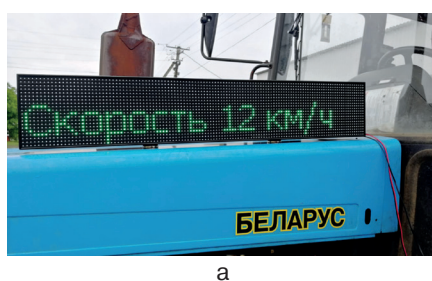
Рис. 4. Трактор Versatile с установленной на кабине информационной системой
