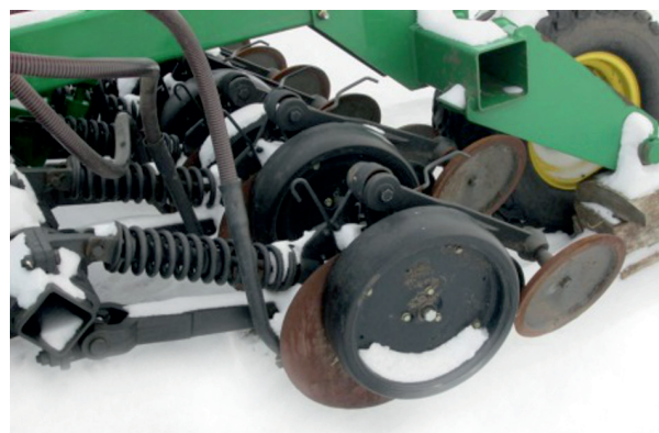
Рис. 1. Пневматическая зерновая сеялка John Deere 1890 (а) и ее высевная секция после наработки 12 тыс. га (б)
