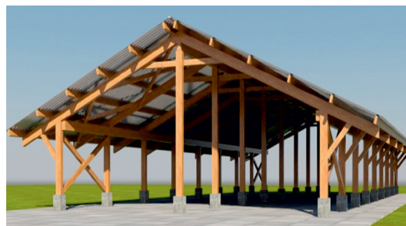
Рис. 2. Примеры использования в конструкции хранилищ элементов из клееного бруса
