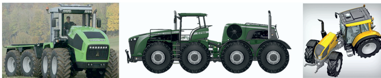
Рис. 4. Усовершенствованная компоновка с шарнирно-сочлененной рамой
