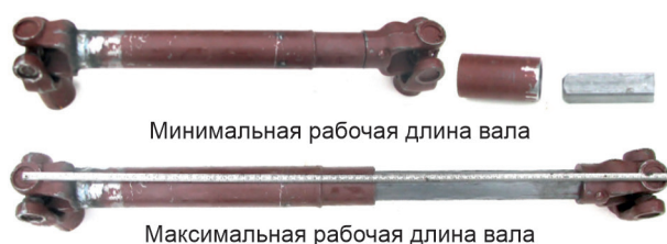
Рис. 5. Карданный вал Н081.02.200-16 после уменьшения длины
