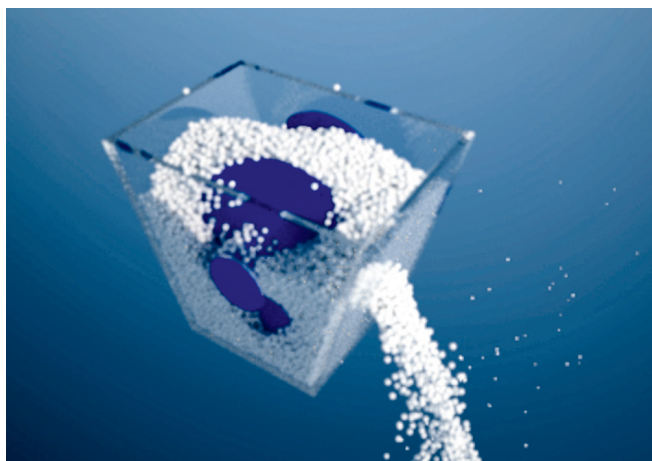
Рис. 2. Визуализация процесса дозирования гранул ТМУ при проведении компьютерного моделирования
