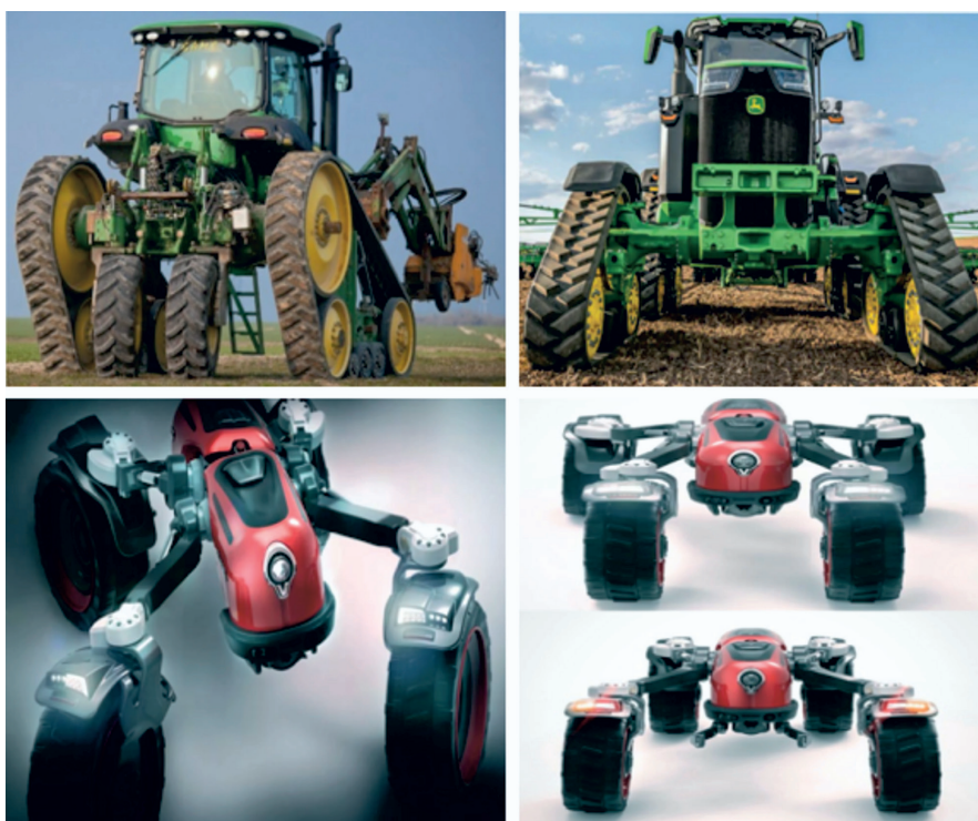
Рис. 5. Шасси с изменяемыми колеями и клиренсом
