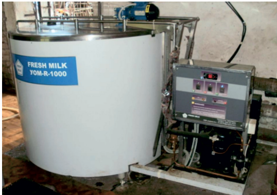
Рис. 2. Резервуар-охладитель молока УОМ-R-1000
