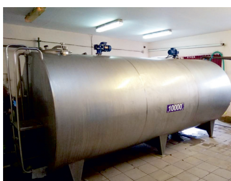
Рис. 7. Охладитель молока закрытого типа ОМЗТ-10000
