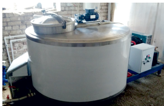
Рис. 5. Резервуар-охладитель молока М4-1000
