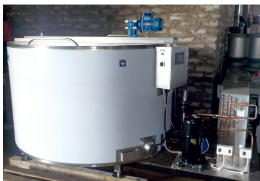
Рис. 4. Резервуар-охладитель молока OMBT-2000
