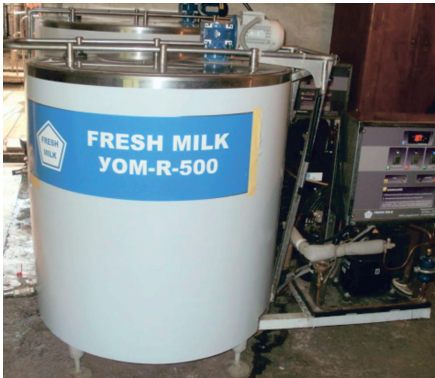
Рис. 1. Резервуар-охладитель молока УОМ-R-500
