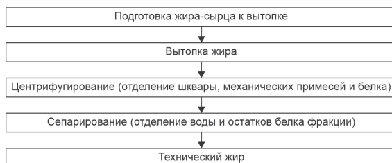
Рис. 2. Технологическая схема переработки жира-сырца в технический жир
