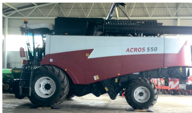
Рис. 2. Взвешивание комбайна на тензометрических весах
