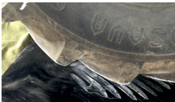
Рис. 1. Определение контурной площади пятна контакта передней шины
