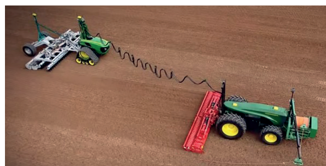
Рис. 3. Автономные электрические тракторы GridCON (а) и GridCON2 (б) компании John Deere
