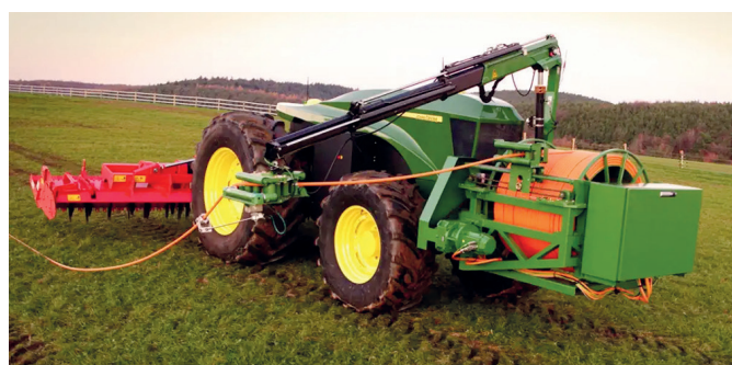
Рис. 3. Автономные электрические тракторы GridCON (а) и GridCON2 (б) компании John Deere
