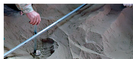
Рис. 2. Гусеничный трактор в почвенном канале (а), установка датчиков в песчаное основание (б)
