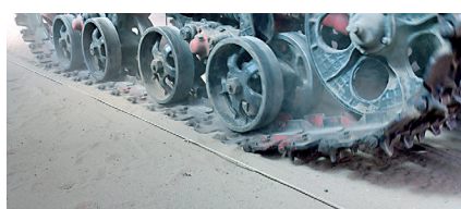
Рис. 2. Гусеничный трактор в почвенном канале (а), установка датчиков в песчаное основание (б)
