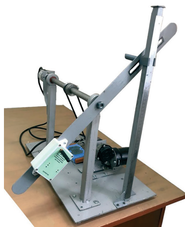
Рис. 5. Стенд для исследований инерциального метода определения глубины хода рабочих органов почвообрабатывающих машин
