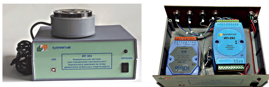
Рис. 1. Информационно-измерительная система ИП-303 (слева) с установленными модулями аналогового ввода ИП-293 (справа)
