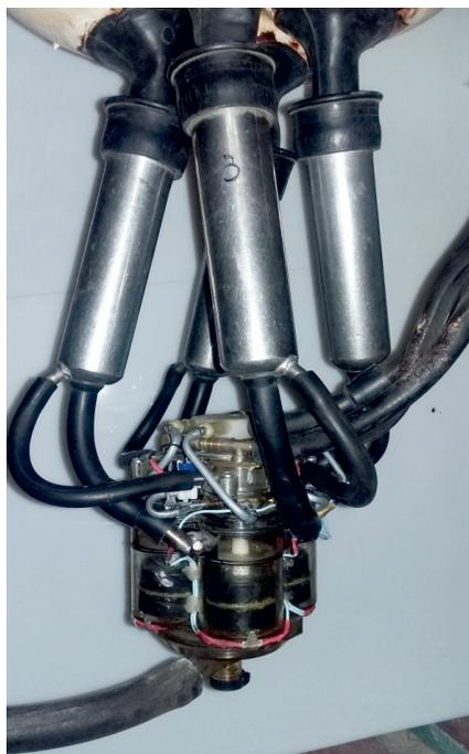
**Рис. 1. Экспериментальный образец доильного аппарата**
