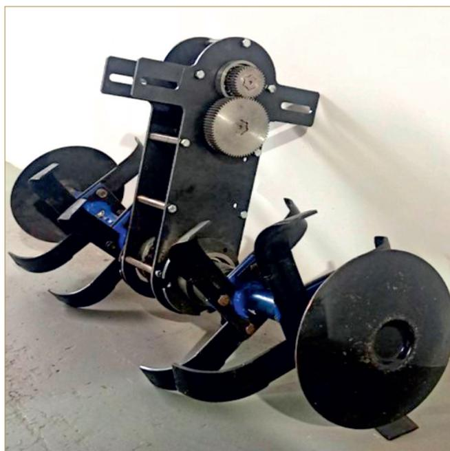
**Рис. 4. Опытный образец навесного почвообрабатывающего фрезерного модуля с комбинированным вращением активных рабочих органов**
