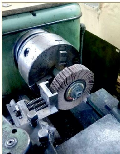
**Рис. 1. Стенд для испытаний образцов на абразивную износостойкость «М1»**
