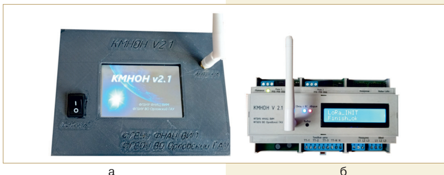
Рис. 2. Внешний вид элементов КМНОН: а – сервер КМНОН; б – модуль мониторинга и управления
