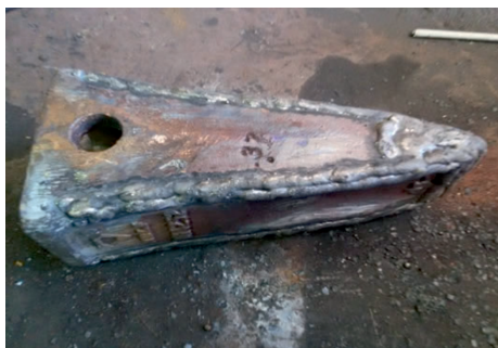
Рис. 4. Зуб ковша экскаватора (изношенный, новый и восстановленный)
