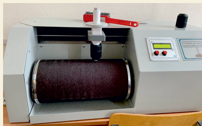
Рис. 4. Установка для измерения абразивной стойкости полимерных и композиционных материалов
