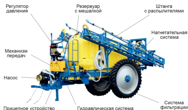
Рис. 1. Основные конструктивные части опрыскивателя
