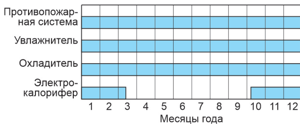
Рис. 1. Интервалы времени, в которые возможно включение оборудования РТВР и противопожарной системы
