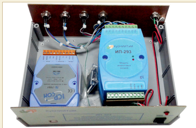
Рис. 5. Установленные в системе ИП-300 модули аналогового ввода ИП-293
