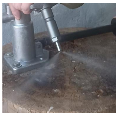
Рис. 3. Результаты исследования форсунки с 50 % биодобавок растительного происхождения
