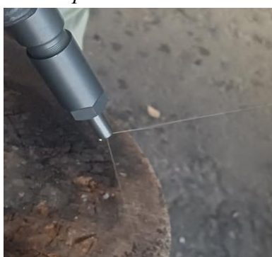
Рис. 5. Результаты исследования форсунки на чистом масле
