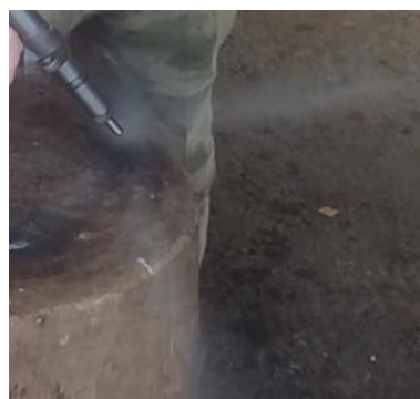
Рис. 2. Результаты исследования форсунки с 25 % биодобавок растительного происхождения
