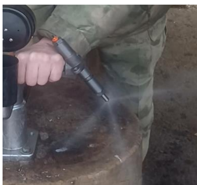
Рис. 1. Результаты исследования форсунки на товарном дизельном топливе
