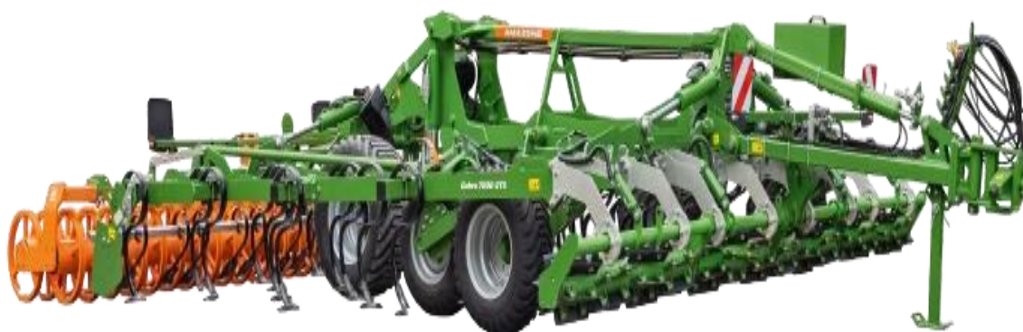
Рис. 2. Модернизированный комбинированный почвообрабатывающий агрегат Ceus с роторным измельчителем стеблей подсолнечника ножом
