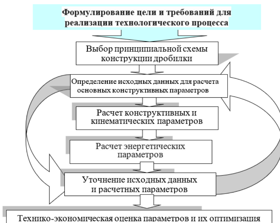
Рис. 2. Этапы проектирования конструктивных параметров дробилки с вертикальным ротором
